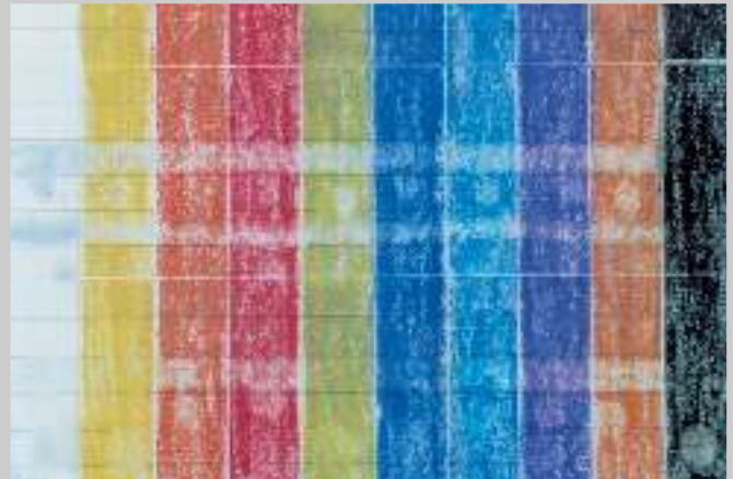
7 Pastellmalerei auf Pergament: Die locker aufliegenden Pigmente werden durch den Laserstrahl abgetragen. Links: etwas verschwärztes Bleiweißpigment. Laserenergien (von oben nach unten): 2x1 J, 1x1 J, 3x1 J (532 nm); 1x1 J, 2x1 J (1064 nm).
