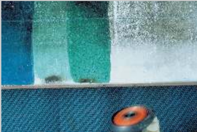
6 In Freskomanier vermalte Muster: blauer Azurit und grüner Malachit. Mit der kleinen, unten sichtbaren Infrarot-Heizquelle, verschwärzen sich die Kupferverbindungen.
